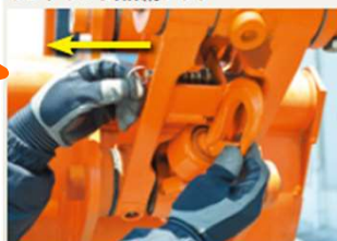
スプリングピンを引いて、フックを固定・取り外す便利な格納構造です。
